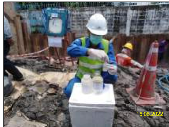
รูปที่ 3-10 การติดตามตรวจสอบคุณภาพน้ำทิ้งจากการทดสอบท่อด้วยวิธีทางชลสถิติ
